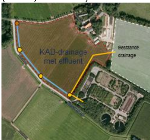
Figuur 5 Sub infiltratie van RWZI effluent in Haaksbergen.
